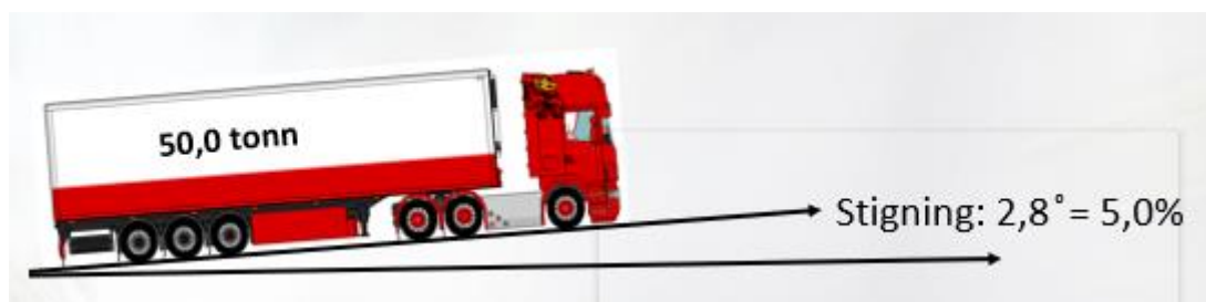
Figur 1: Tegning som viser 5% stigning for et vogntog på 50 tonn (NLF)
